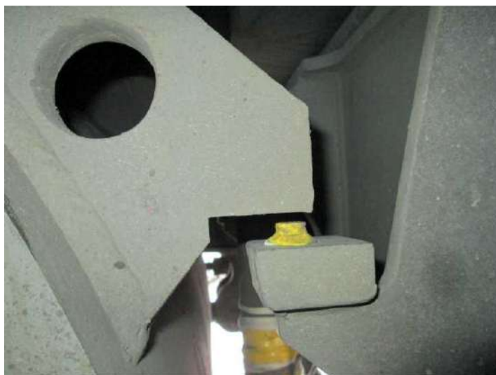
Рисунок 3.4 – Остаточная деформация пластилина, закрепленного между страховочными приливами 1-го ТЭД
